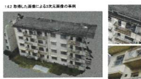
図1.14 建築物の3次元点群画像の例
